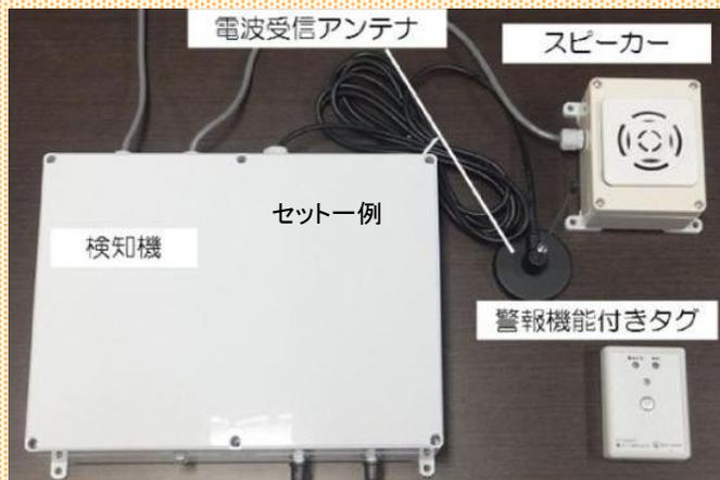
周囲の障害物・作業者を検知し音で警告！接触事故防止のお役に立ちます。
