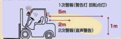
取り付けした超音波センサーが、車体後方の人や物体までの距離を検知し、警告音と回転灯でオペレーターに注意を促します。
